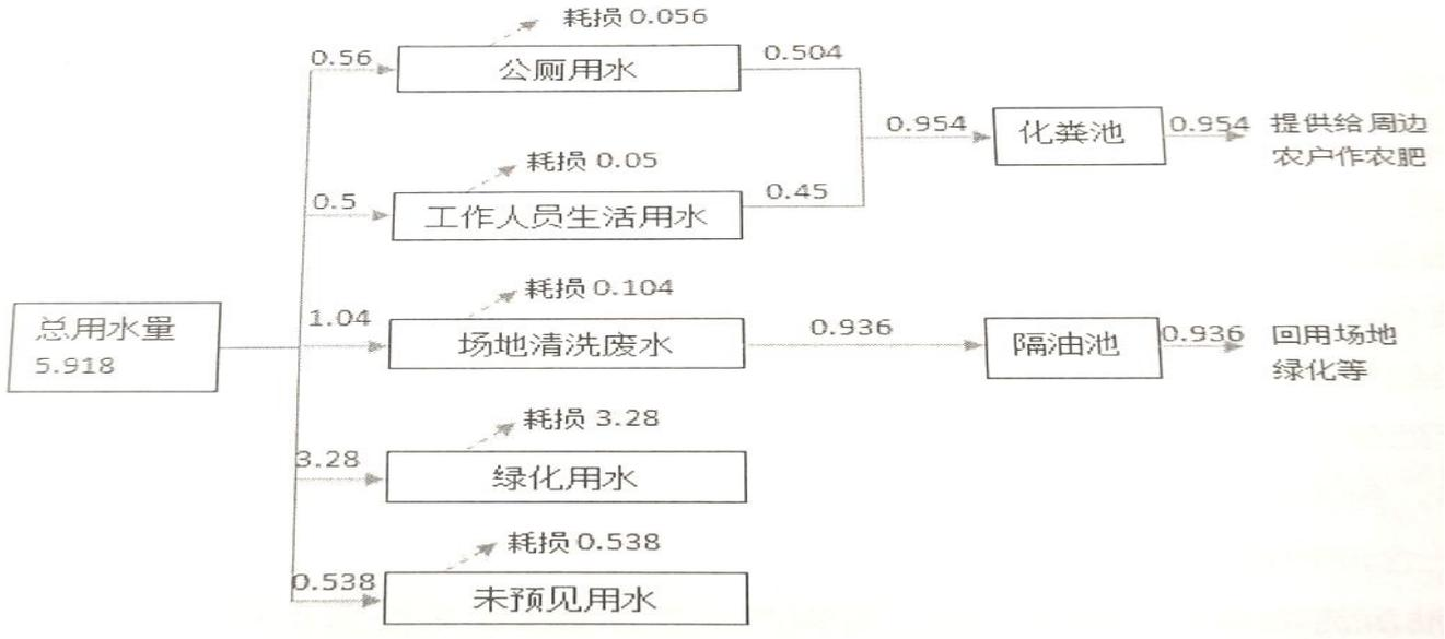
图3-1 水平衡图 单位  $\text{m}^3/\text{d}$
